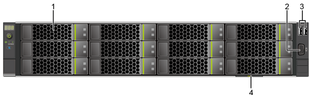
图4-1 12x3.5 英寸硬盘配置前面板组件
